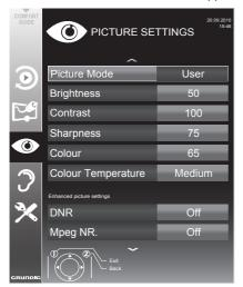
Select the line »Picture Mode«, »Brightness«, »Contrast«, »Sharpness«, »Colour«, or »Colour Temperature« with »V« or »A«. Select the value with »<« or »>« and press » « to confirm.
